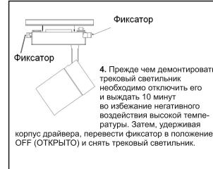
4. Прежде чем демонтировать трековый светильник, необходимо отключить его и выждать 10 минут во избежание негативного воздействия высокой температуры. Затем, удерживая корпус драйвера, перевести фиксатор в положение OFF (ОТКРЫТО) и снять трековый светильник.
